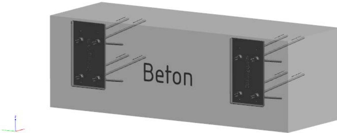
Anwendungsbeispiel: Betonfundament mit einbetonierten Gewindehülsen, Pfostenbefestigung mittels Pfostenschuh
