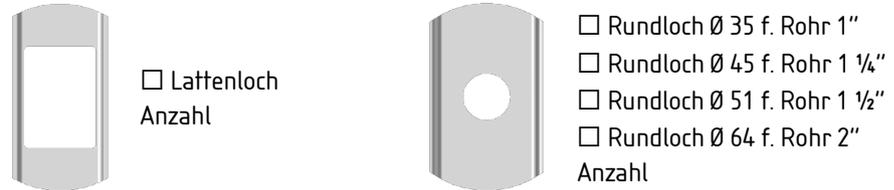
3. Bitte tragen Sie die gewünschten Längen und Lochabstände in die geeignete Skizze ein. Falls Sie zusätzlich Ösen, Drahtzaunlöcher oder eine Verstrebung wünschen, bitten wir Sie, die jeweilige Skizze selbst zu erweitern. Hierfür stehen Ihnen folgende Möglichkeiten zur Verfügung:
